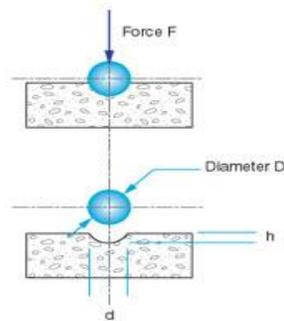
**Figure 32 : Brinell hardness test**
